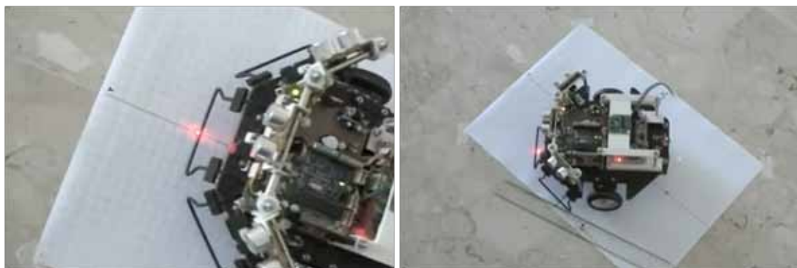
Imágenes 3 y 4. Test odométrico que muestra la precisión del Robot Rino con respecto a su posición espacial. Fuente: https://www.youtube.com/watch?v=d7KZDPJW5n8 Accedido 2014-06-04
