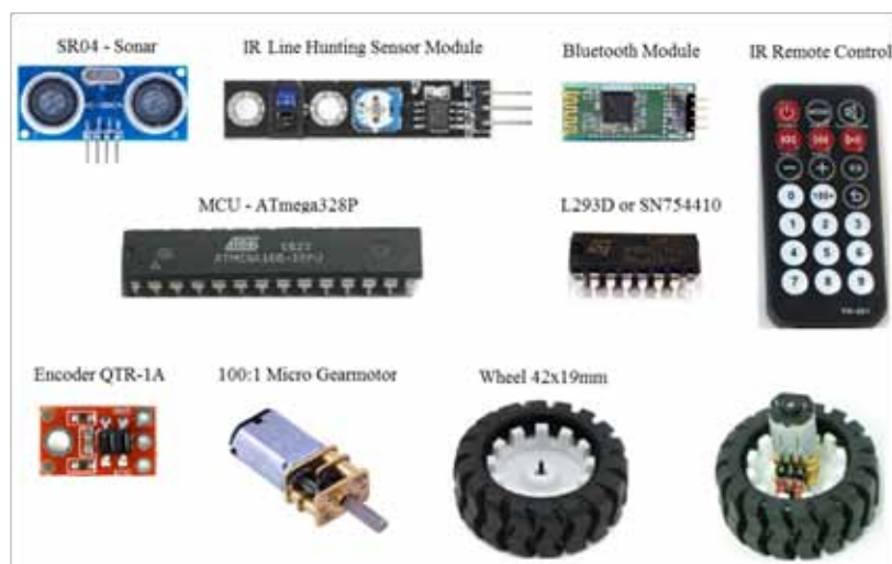
Imagen 6. Componentes de hardware del dispositivo electrónico.
